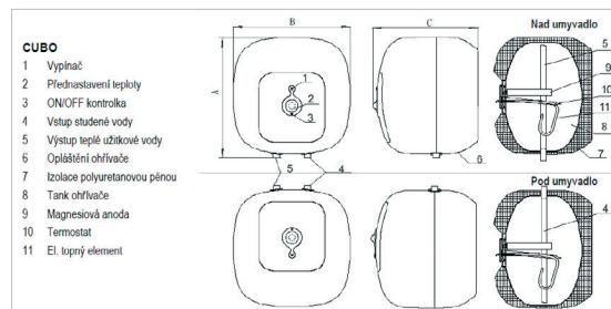
Všechny ohřívače jsou napájeny napětím 220–240 V 50/60 Hz a mají elektrické krytí IPX4
