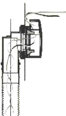
**D** Die Verwendung des ovalen Griffs ermöglicht die Wasserhöhe bis zum Überlauf um 5 cm zu erhöhen (Abb. B);
