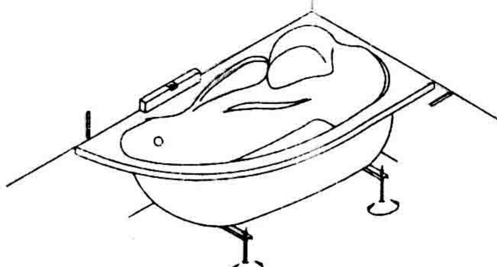
Podle obrázku 3 si vyznačte na obklad tužkou umístění vyrovnané vany k obkladu. Vanu odsuňte a pomocí hmoždinek (8), vrutů (12) příšroubujte ke zdi „S“ plíšky (7). Vanu shora zasuňte do příšroubovaných „S“ plíšek (7).
