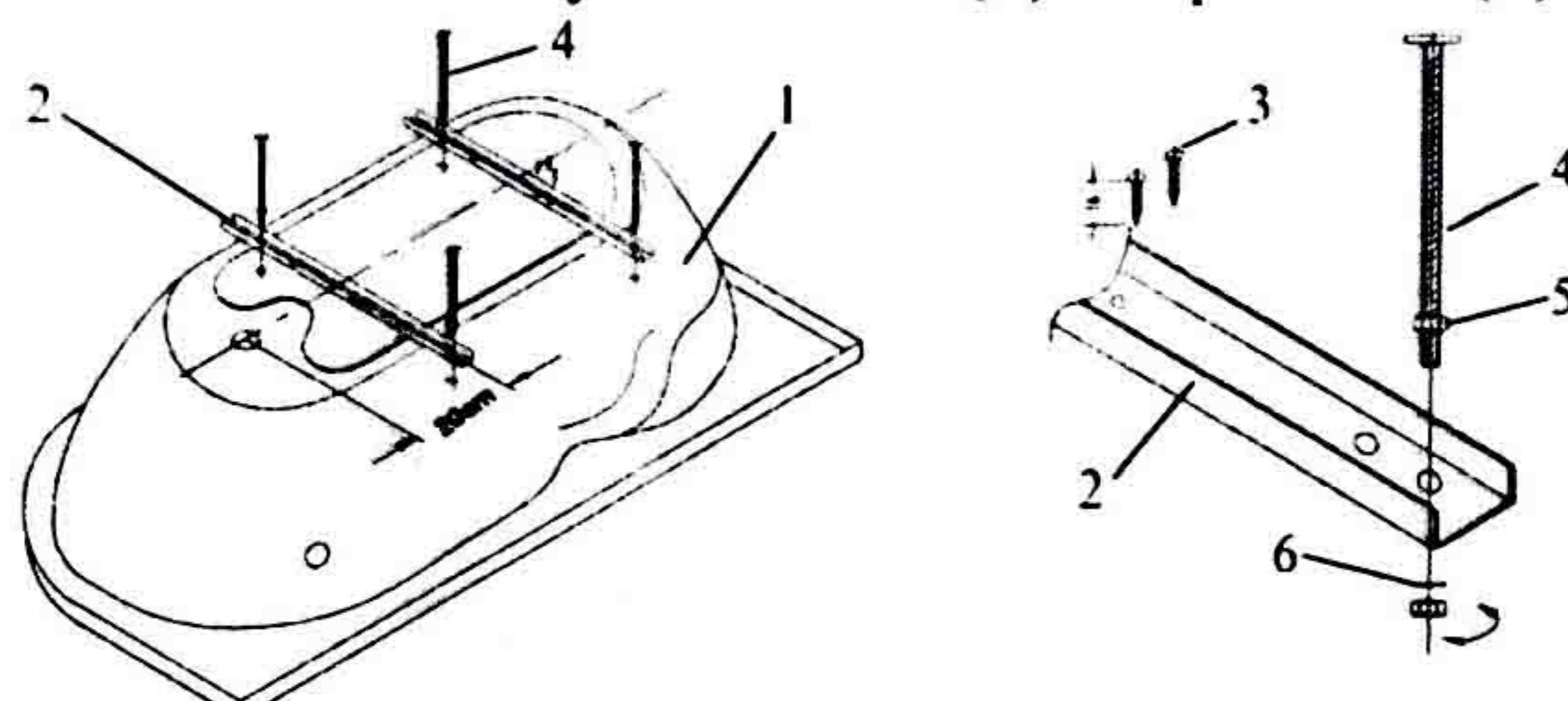
Podle obrázku 2 usad'te vanu do stavebně připraveného prostoru a podle vodováhy ji vyrovnejte. Otáčením závitových tyčí s nožičkou (4) v maticích (5) docíllete zvyšování respektive snižování vany až docílите podle vodováhy rovinnost.
